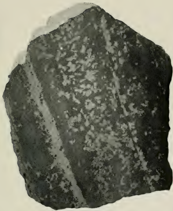
Structure zonée sur la surface polie du minéral de Nickel Plate. Minéral de Nickel Plate montrant de l'arsenopyrite (taches blanches) disséminée à travers une gangue de grenat et épidote, ou disposée en bandes le long du plan de stratification primitive de la roche.
